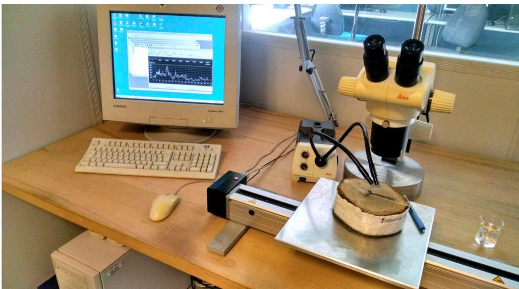
Figura 10 – LINTAB™, strumento utilizzato per la misurazione delle ampiezze degli anelli di accrescimento (foto Maria Chiara Chistè).
