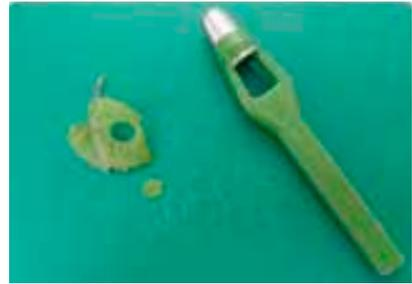
Figura 8 – Strumento utilizzato per campionare il materiale vegetale (1 cm).
