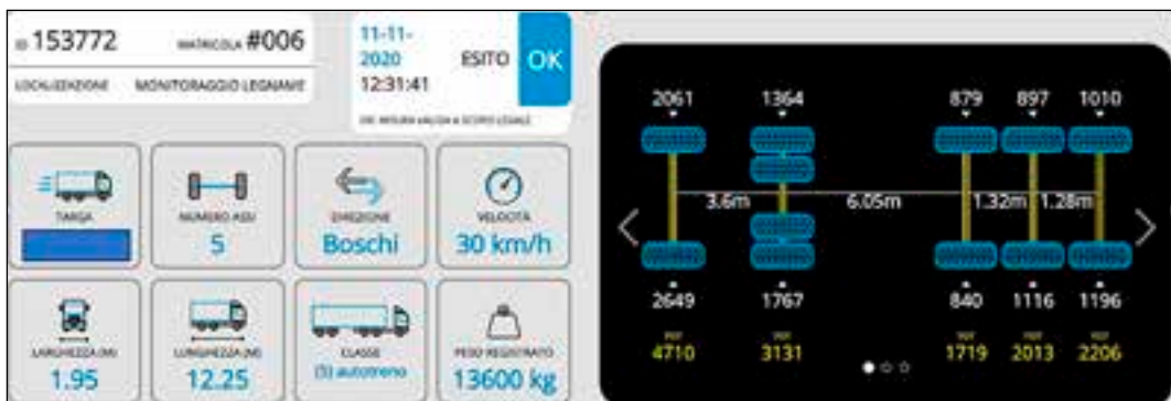
Foto 3 – Interfaccia grafica con riportati i parametri dimensionali e di massa del mezzo e numero assi.
