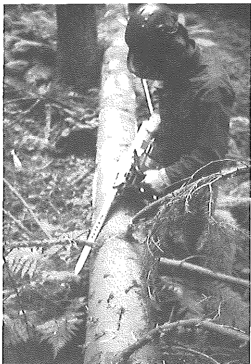
Sramatura dei tronchi con il metodo a leva: durante il lavoro la motosega viene appoggiata sul tronco oppure sulla coscia dell'operatore. Si riducono in questo modo il peso e le sollecitazioni che diversamente graverebbero totalmente sulle braccia (Foto Pozzatti).
