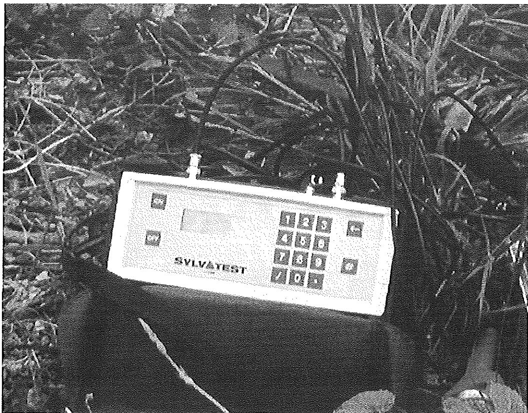
Fig. 9 - Il Sylvatest è un apparecchio ad ultrasuoni per determinare, come lo strumento della figura precedente, le proprietà meccaniche sia dei segati sia delle piante in piedi.
