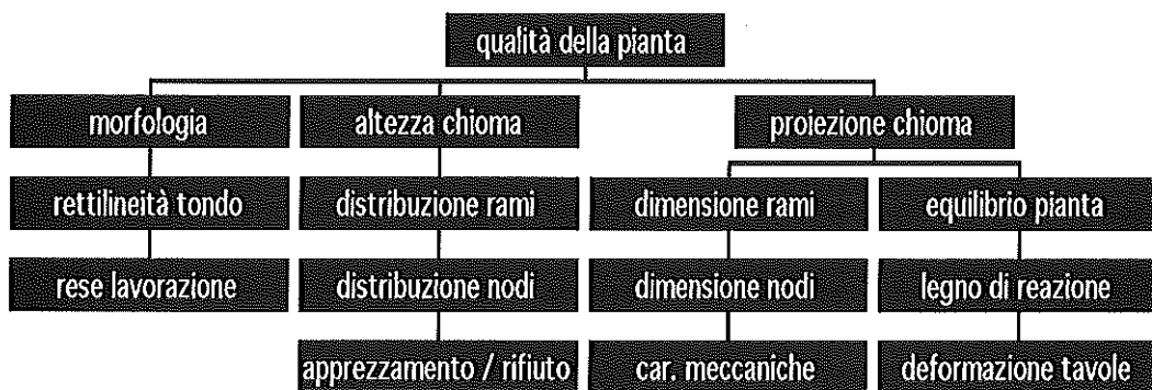
18 Fig. 2 - Principali caratteristiche che permettono di determinare la qualità dei fusti.
