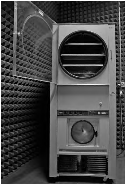
Figura 10 - Il liofilizzatore della Soprintendenza (Virtis General Purpose Freeze Dryer mod.24Dx48)
